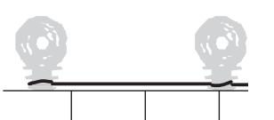
**3** Het uiteinde van de tweede rol kunststofdraad bevestigt u aan het oog van de eerste isolator. Vervolgens legt u de draad in de ogen van alle verdere isolatoren en bevestigt u de draad, nadat deze strak getrokken is, aan het oog van de laatste isolator.
