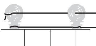
**3** Den Anfang der zweiten Drahtrolle binden Sie an der obersten Öse des ersten Isolators wie gezeigt fest. Dann ziehen Sie den Draht durch die jeweils oberste Öse aller Isolatoren und binden den Draht am letzten Isolator fest.
