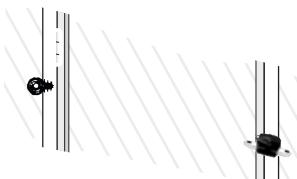
**2** Pour construire une porte, vissez un isolateur sur la structure de la volière, du même côté que les charnières de la porte. Vissez un isolateur d'ancrage vert du côté opposé.
